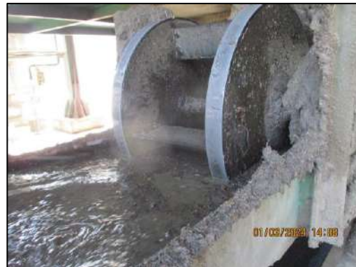
รูปที่ 2-24 หัวสเปรย์น้ำและช่องแช่ถังของสายพานลำเลียงถ่าน
