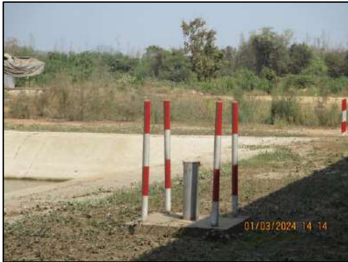
รูปที่ 2-36 บ่อสังเกตการณ์บริเวณระบบบำบัดน้ำเสีย
