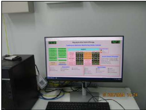
รูปที่ 2-5 หน้าจอแสดงผลตรวจวัดก๊าซคาร์บอนมอนอกไซด์และก๊าซออกซิเจนภายในหม้อไอน้ำ
