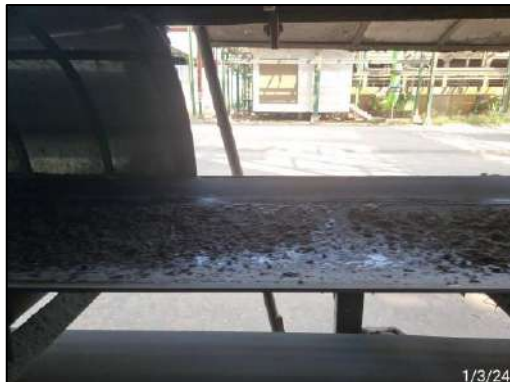
รูปที่ 2-24 หัวสเปรย์น้ำและช่องแช่ถังของสายพานลำเลียงถ่าน
